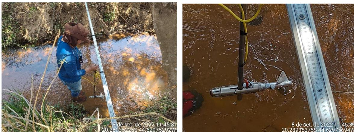
Figura 2.2 Medição de vazão com micro molinete.
